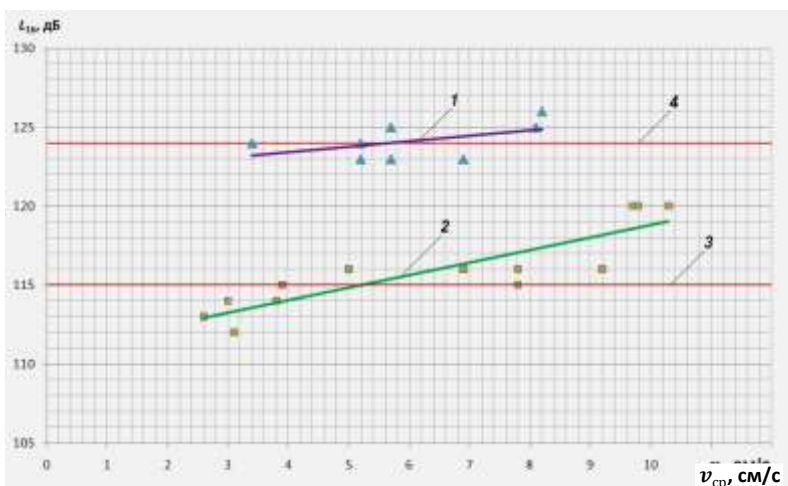
Рис. 3. Зависимость уровней виброскорости L_{16} в октавной полосе 16 Гц от средней скорости внедрения пика v_{cp} при разрушении углецементного блока:
