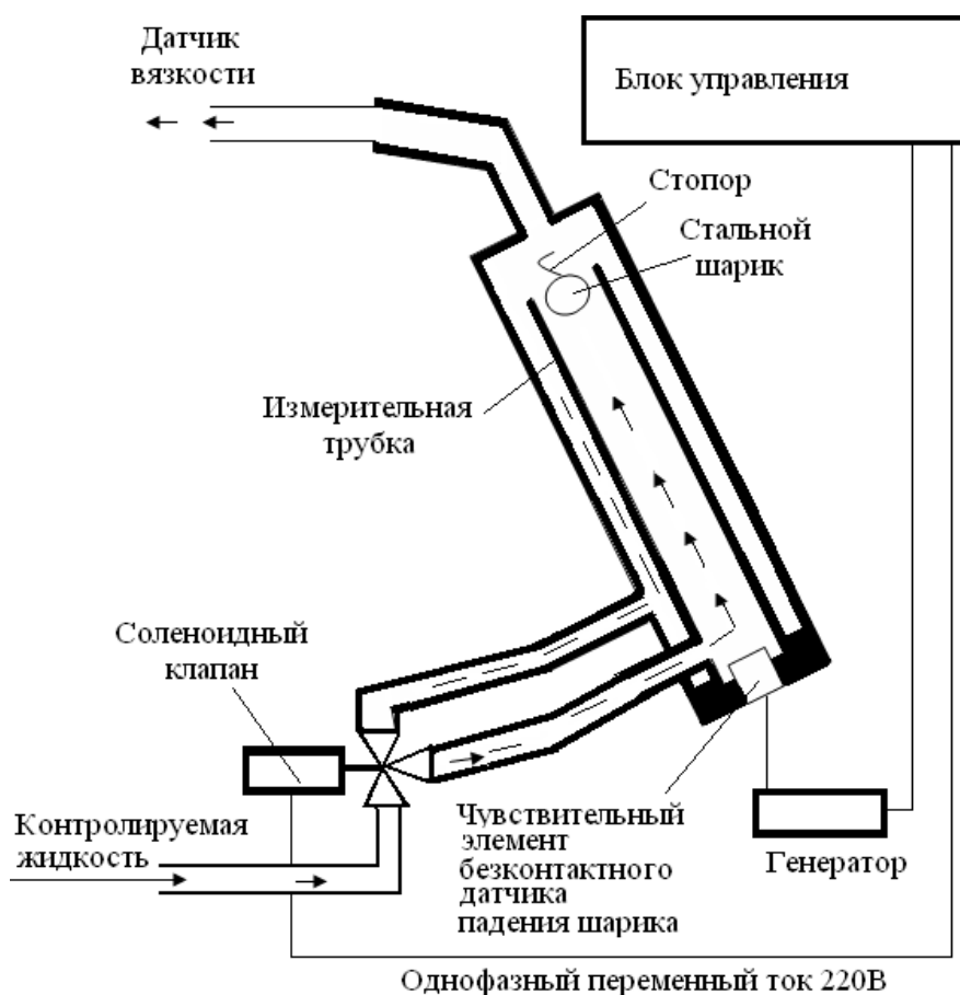
Рис. 3 – Схема поточного вискозиметра с падающим шариком, модели JSW.
