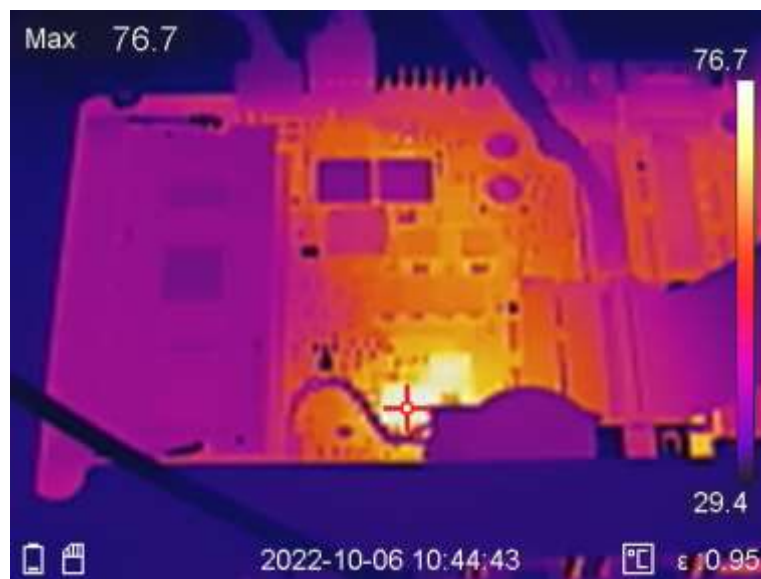
Рис.2. Распределение температур на поверхности материнской платы.
