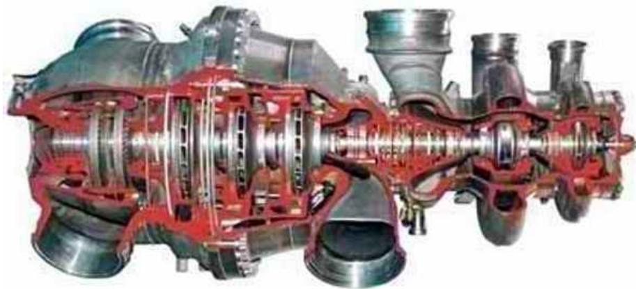
Рис.1. Пример турбонасосного агрегата последнего поколения [1]
