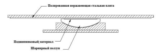
Рис.1. Устройство плоского маятникового подшипника - сейсмоизолятора
