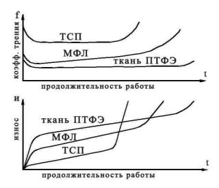
**Рис.2.** Характерный вид зависимостей трибологических характеристик от продолжительности работы различных типов покрытий
