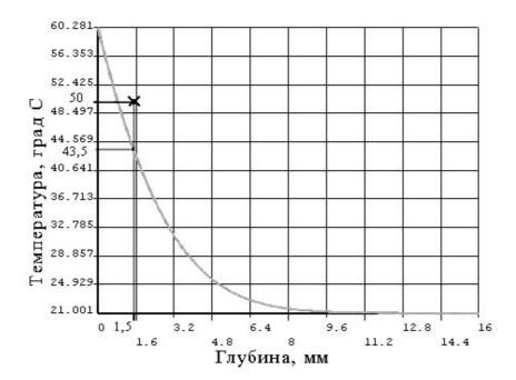
**Рис. 7.** Расчетное распределение суммарной температуры по глубине (x -эксперимент №2). Вертикальной линией отмечена точка, в которой производился замер температуры.
