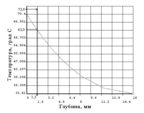
**Рис. 8.** Расчетное распределение суммарной температуры по глубине (х -эксперимент №4). Вертикальной линией отмечена точка, в которой производился замер температуры.
