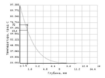
**Рис. 6.** Расчетное распределение суммарной температуры по глубине (x -эксперимент №1). Вертикальной линией отмечена точка, в которой производился замер температуры.
