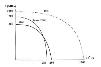
**Рис.3.** Зависимость несущей способности от температуры для различных типов покрытий
